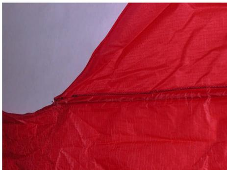
**5. Tunnel nähen:** Der Tunnelstreifen wird nach oben geklappt und an den Kielen genäht. Hierbei darauf achten, dass eine kleine Öffnung bleibt durch die später der Gfk-Stab
